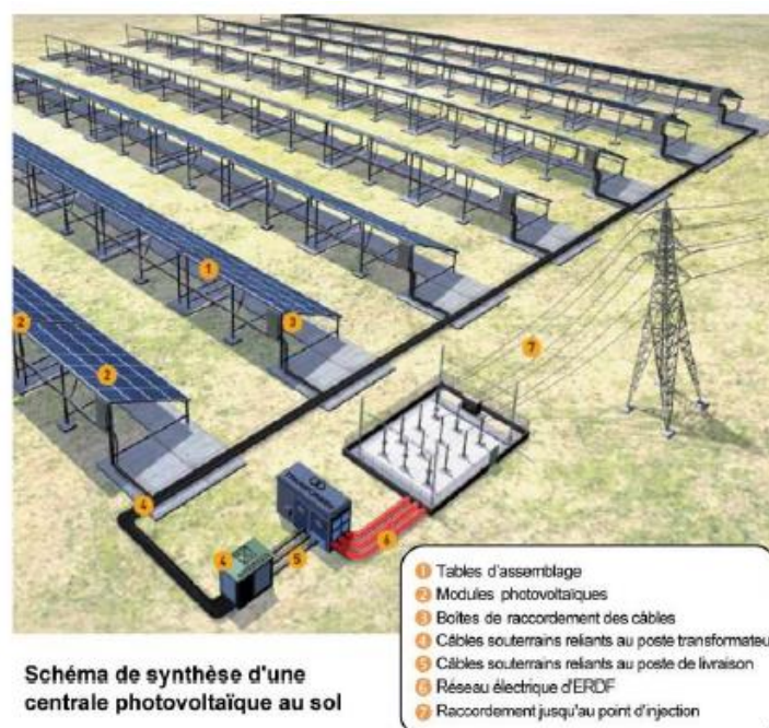
Figure 2 : Schéma d'une centrale photovoltaïque (Source : ENCIS Environnement)
